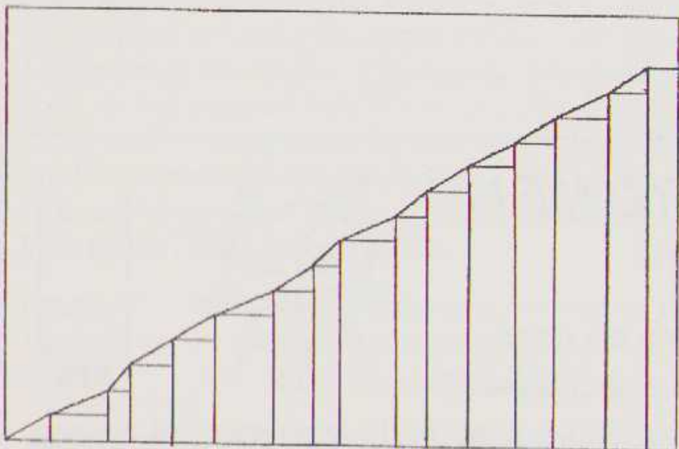
Fig.4 Het effect van jitter bij een perfecte D/A-converter.
